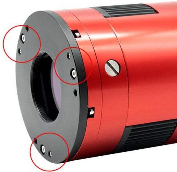
1. 使用相机正常拍摄出带星点的图像，通过软件找出图像中哪个方向存在倾斜问题，然后调整与图像对应的相机上的一组或多组法兰调节螺丝。
