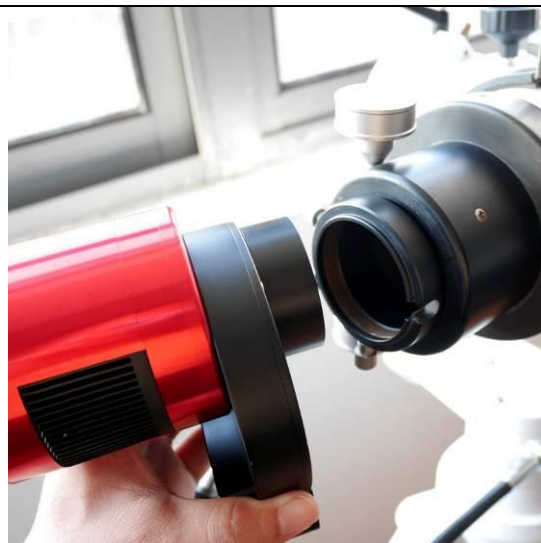
用 2"转接环 T2 扩展器可用于连接望远镜。
