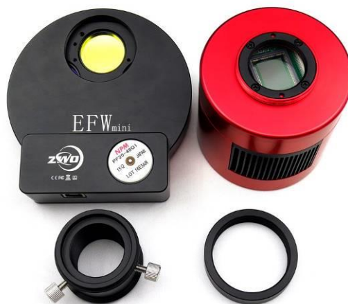
拧下 EFW 上 M42-1.25" 转接口，拧下 1600 相机上的 M42 延长环。
