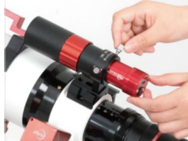
2. 将导星相机装在导星镜上，并拧紧锁紧螺丝
