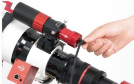
3. 用标配的Type-C数据线，连接导星相机的type-c接口
